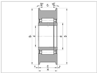
滚轮轴承是一种特殊的滚动轴承，主要用于支撑机械旋转体，降低运动过程中的摩擦系数，并保证回转精度。滚轮轴承是一种由主滚轮、侧滚轮、轴头和盖板组成的密封结构轴承。其核心部件包括：主滚轮：主要承受垂直方向的载荷和冲击负荷，具有很强的耐冲击性、耐磨性和抗腐蚀性。侧滚轮：主要承受水平方向的载荷，同样具有耐冲击性、耐磨性和抗腐蚀性。
